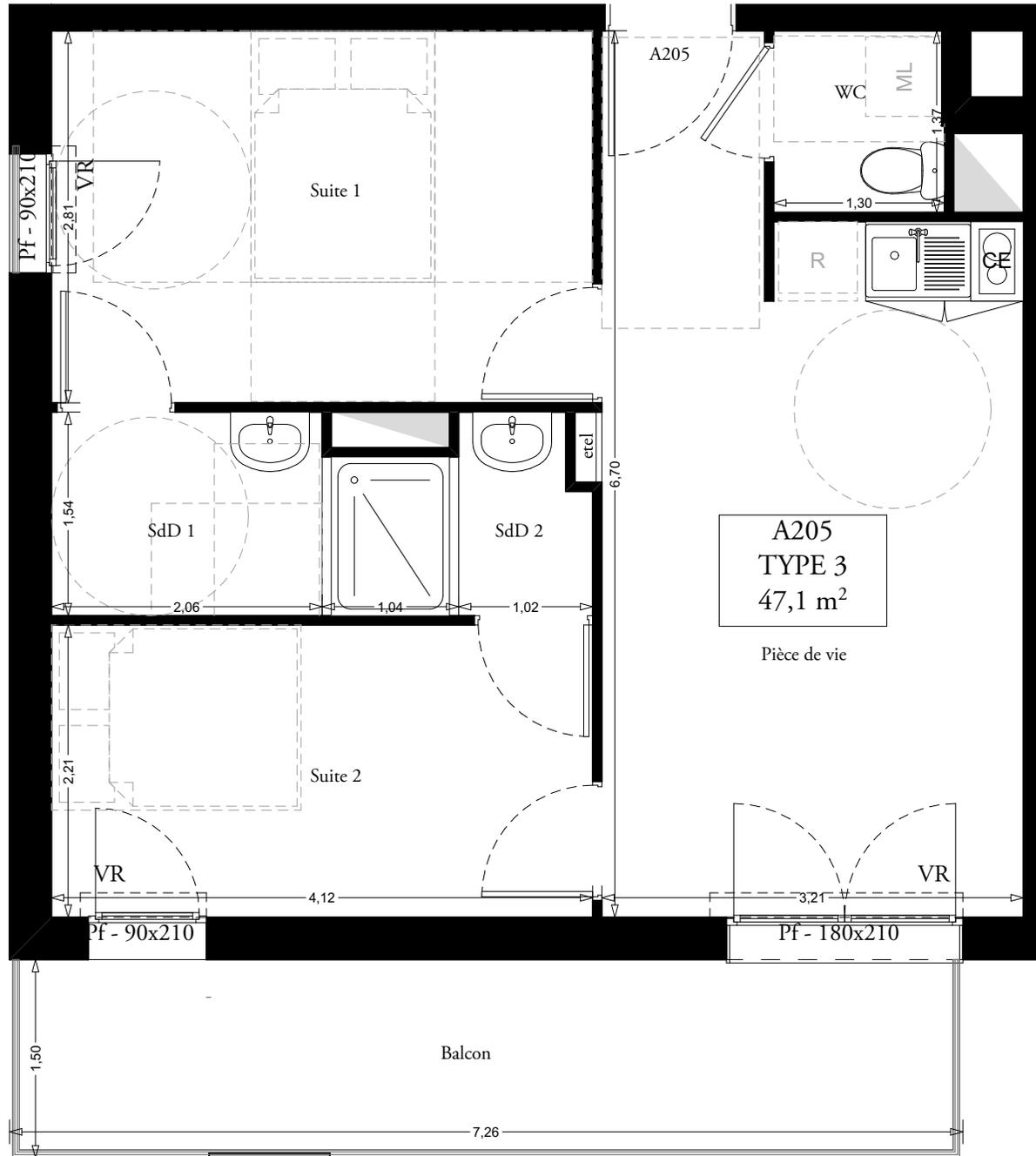
LEGENDE : PF : Porte-Fenêtre / F : Fenêtre / VR : Volet roulant / etel : Tableau électrique / Pl. Placard / Tél : espace télétravail / TRI : Emplacement tri sélectif / R : Emplacement réfrigérateur / LL : Emplacement lave-linge / LV : Emplacement lave-vaisselle / Soffite, Faux-plafond :
